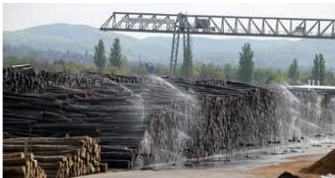
Slika 99: Zaščita hlobovine s pršenjem vode (X)
