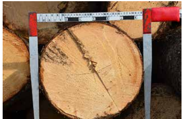
Slika 11: Merjenje premera čela hloda (X)
