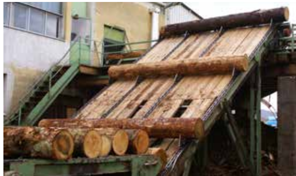
Slika 95: Prečni verižni transporter pred žagalnico (U. G.)
