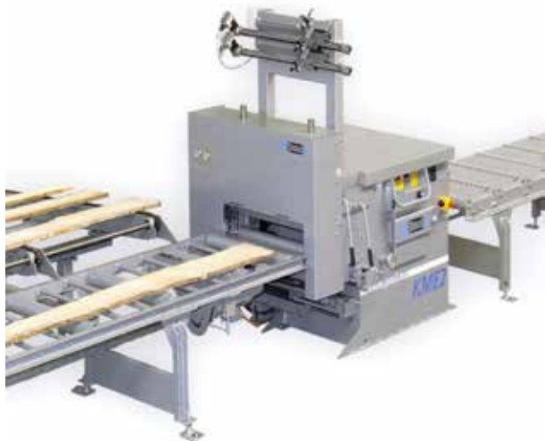
Slika 193: Dvostranski večlistni robilnik z laserskimi senzorji (X)
