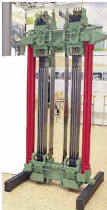
Slika 129: Jarem s širinsko premaknitvijo žaginih listov (X)
