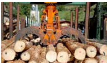
Slika 91: Klešče s hidravličnim rotatorjem (X)
