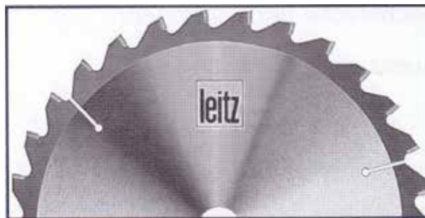
Slika 197: Krožni žagin list za čeljenje z negativnim cepilnim kotom ( \gamma )
