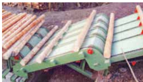
Slika 96: Prečni verižni transporter iz več sekcij (X)
