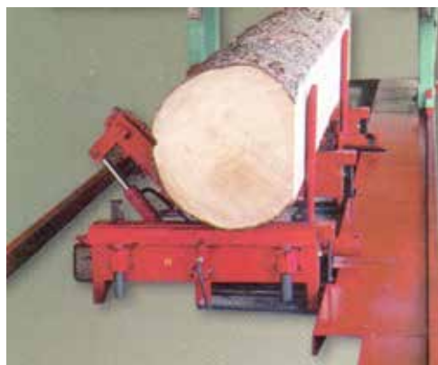
Slika 175: Obračalnik hloda (levo) in kotni prislon (desno) (X)
