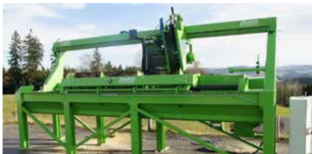
Slika 105: Stroj z rezkalno glavo in verižno žago (X)
