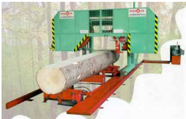
Slika 173: Horizontalni tračni hlodovni žagalni stroj (X)
