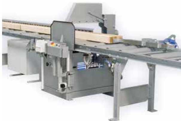
Slika 195: Podmizni nihalni čelilnik (X)
