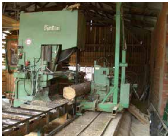
Slika 155: Vertikalni tračni hlodovni žagalni stroj (X)
