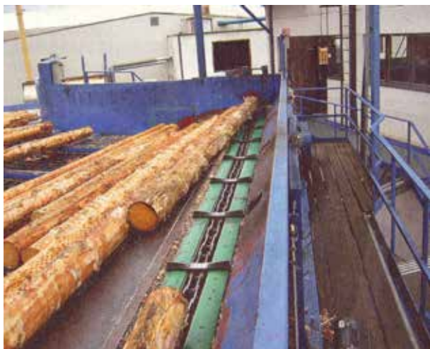
Slika 94: Vzdolžni verižni transporter s členasto lamelno verigo (X)
