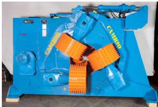
a) lupilnik z valji za centriranje in podajanje hloda
