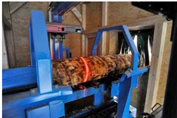
Slika 106: Merjenje premera hloda (X)
