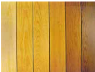
Slika 358: Sprememba barve borovine glede na stopnjo modifikacije, ki narašča od leve proti desni (X)
