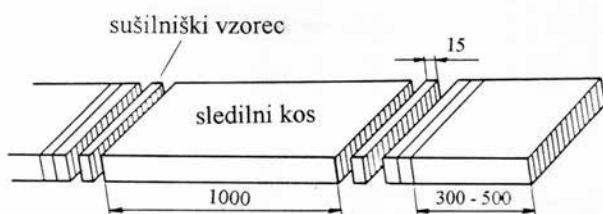
Slika 301: Prikaz izdelave sledilnega kosa in sušilniških vzorcev iz kontrolne deske (8.: 57)
