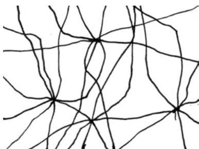
Slika 219: Duroplasti – molekularna zgradba je zamrežena (Z. S.)
