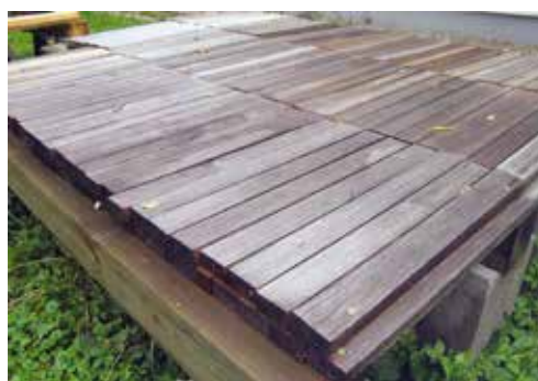
b) terenski test naravne odpornosti lesa – IV. razred izpostavitve
