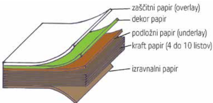
Slika 272: Zgradba laminata (Z. S.)
