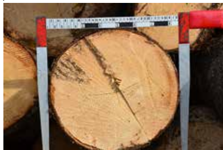
Slika 181: Merjenje premera čela hloda – 5 cm od konca (X)
