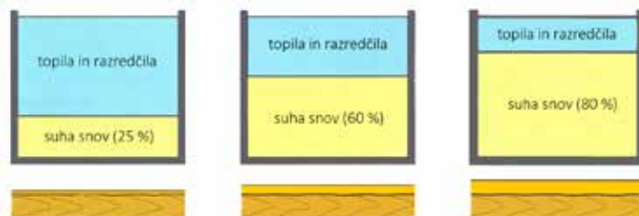
Slika 230: Odvisnost debeline utrjenega laka od suhe snovi (S. K.)
