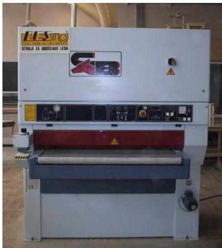
Slika 88. Kontaktni brusilni stroj
