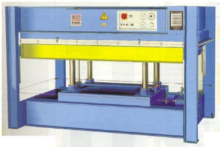
Slika 86. Enoetažna hidravlična stiskalnica
